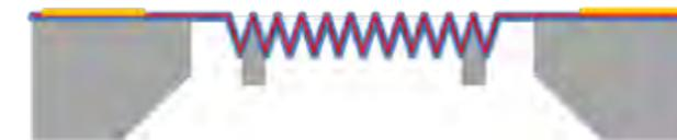
Schematischer Schnitt durch einen MEMS-IR-Strahler mit texturierter aktiver Heizmembran
