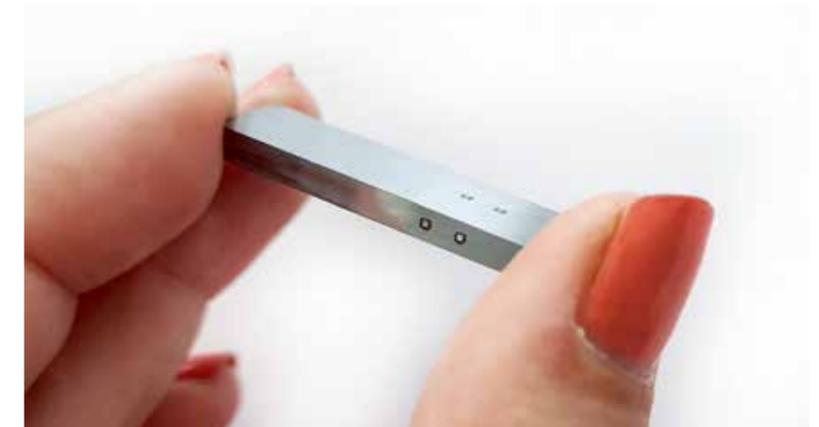
Silizium-Dehnmesstreifen (Si-DMS) auf metallischem Probekörper als Demonstrator
