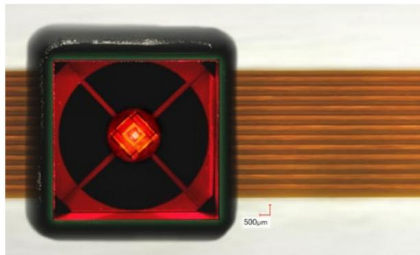
Industrialisierbare kompakte optoelektronische Strahler-Empfänger-Einheit mit zentral über der LED in der Strahlergrube angeordnetem Diamant
