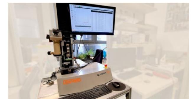
Nanoindenter, verwendet mit einer Zugprüfmaschine.
