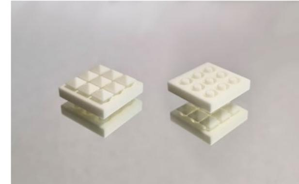
Ausschnitt der Kontaktplatte für eine Matrix aus 3 \* 3 Sensoren, welche in die Greiferplatte integriert ist
