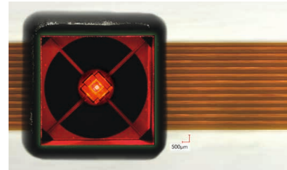
Miniaturisierte, siliziumbasierte Strahler-Empfängereinheit mit integriertem NV-Zentren-haltigem Diamant, die eine zentrale LED und vier konzentrische Photodioden umfasst.
