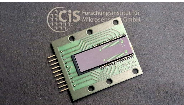
Fertig aufgebaute „optoelektronische Baugruppe mit Fotodioden-Array und Winkelfilter“ auf Träger-Platine
