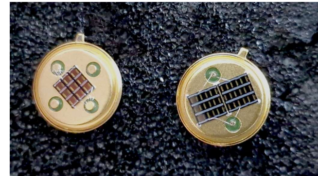
Demonstratoren aus dem FIRE-Projekt: monolithisch integriertes Array aus neun aktiven Teilflächen bzw. zwei Arrays mit jeweils neuen Teilflächen.
