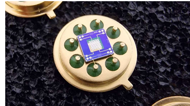
Demonstrator eines gegenüber Wärmeleitung aus der Umgebung toleranten Thermopiles aus dem MyTZe-Projekt.
