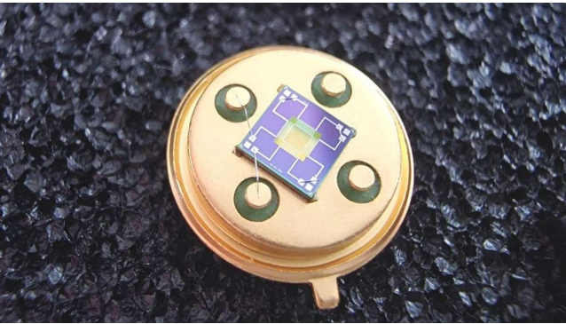
Thermopile-Chip auf TO-Sockel mit photonischen Strukturen aus dem Projekt PhIR-10
