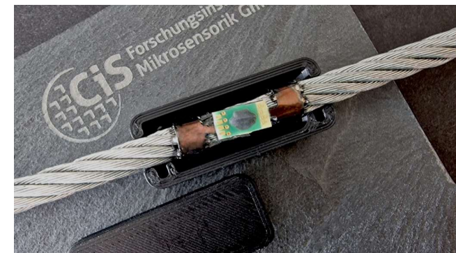
Dehnungssensor in Verbindung mit einer Halterung
