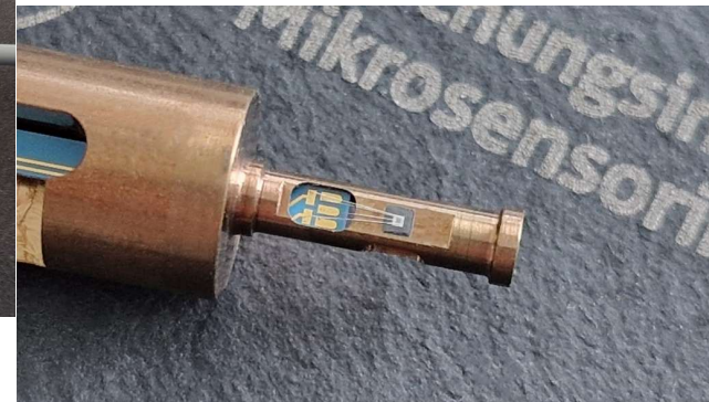
Bild 8: Drucksensor unter Verwendung von Si-DMS mit frontbündigem Medienkontakt und ölfrei. (DS 300 MPa)
